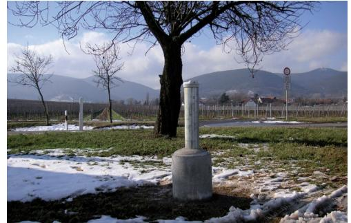
► Grundwasserbeobachtungsrohr (Foto: LfU-RP)
