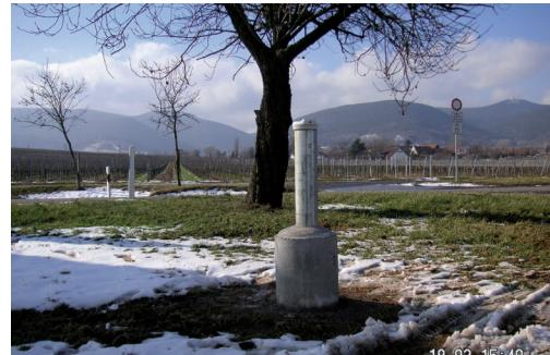
► Piézomètre de contrôle des eaux souterraines (Photo : LfU-RP)
